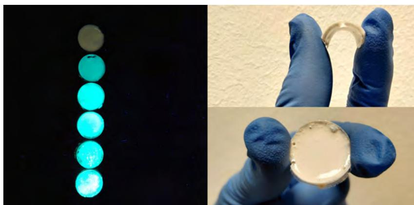
Serie dei fosfori ridotti (ZnO:Zn) inglobati in resina silconica eccitati con luce UV (sinistra), test di flessibilità sui multi-strato (destra).
