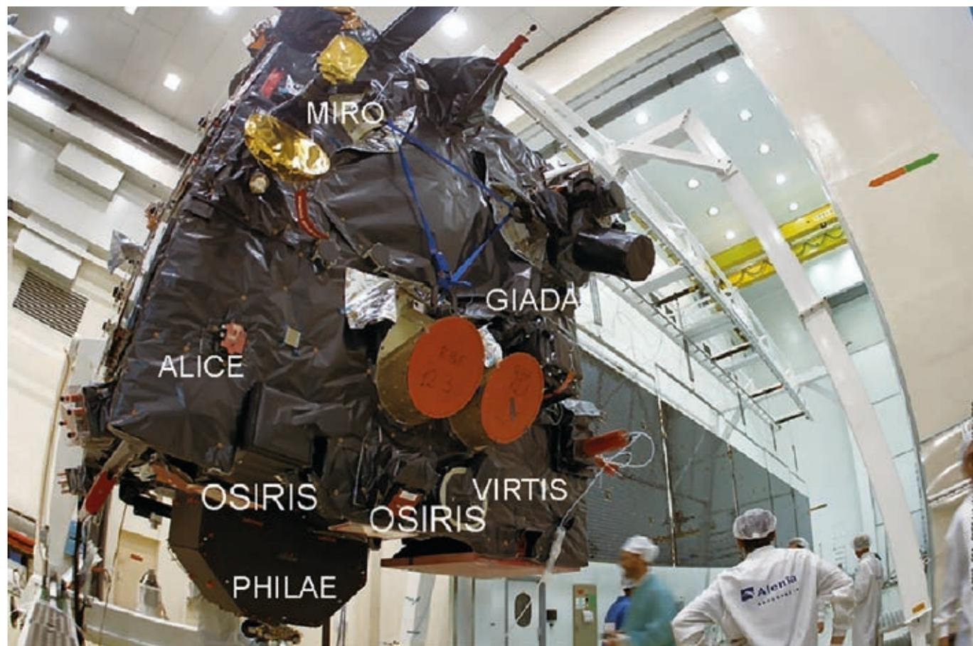
L'astronave Rosetta, con indicati alcuni tra gli strumenti scientifici, tra cui i due occhi di OSIRIS, VIRTIS e GIADA. Sul retro sporge parte del modulo di atterraggio Philae. Sulla destra si vede uno dei due pannelli solari, i più grandi ed efficienti mai lanciati nello spazio. Foto realizzata nel 2002 in fase di montaggio finale nei laboratori di Alenia Spazio a Torino.
