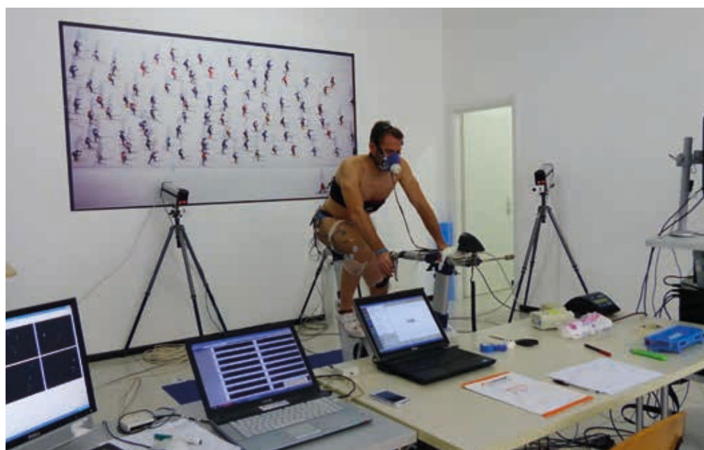
Figura 1: Sistema integrato per la misura delle prestazioni fisiologiche e meccaniche del ciclista (CeRISM)
