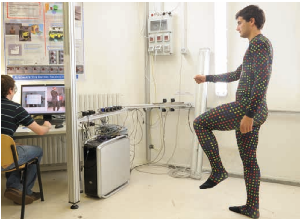
Figura 2: GaMoCap (Garment Motion Capture) sistema ibrido di ricostruzione tridimensionale del movimento (Laboratorio Meccatronica-UniTn)
